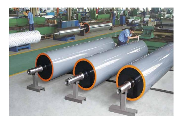
较高的生产线速度要求流延膜用辊筒具有极高的转速、精确的动平衡精度、快速均衡的热交换效率;
