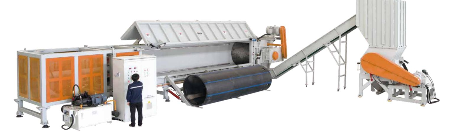
DYSSG系列撕碎机组可用于直径1600MM的PE、PP、PVC管材撕碎,长度达3-6M的管材直接破碎,无需分割,其转速缓慢运转平稳,各种管材放入水平的喂料槽中,喂料槽自动关闭由液压推进将管材推向轴中心进行破碎。撕碎后的材料通过输送机带入破碎机进行二次破碎完成需要的破碎颗粒直径。
